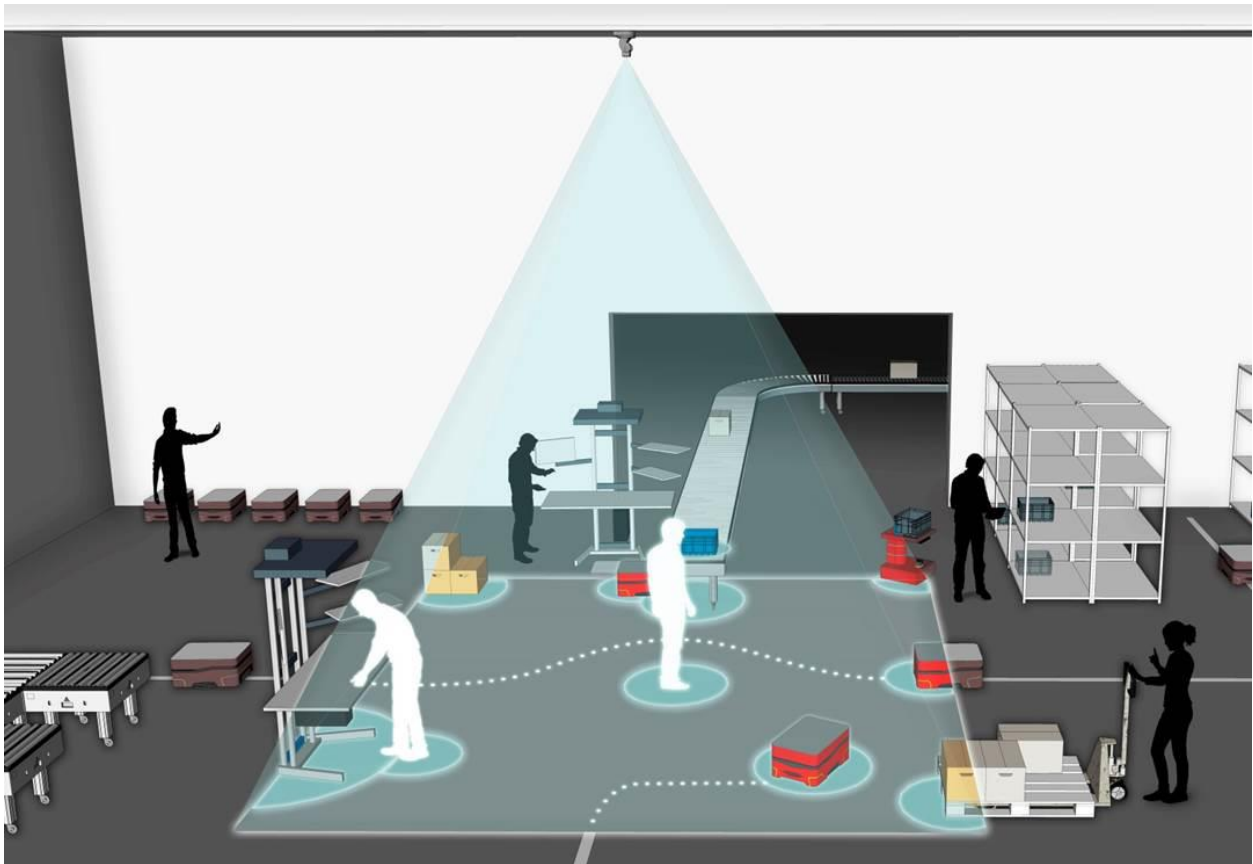
Abbildung 1: Gesamtsystem bestehend aus der externen Lokalisierungseinheit, einer optischen Spurführung und fahrerlosen Transportfahrzeugen.
